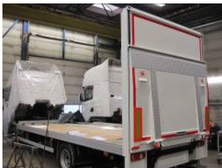
Modulair gebouwd achterportaal bij IJntema Carrosseriebouw.
