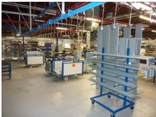
Verlenging aanvoerbaan coating tot aan de vernieuwde puntlasafdeling.
